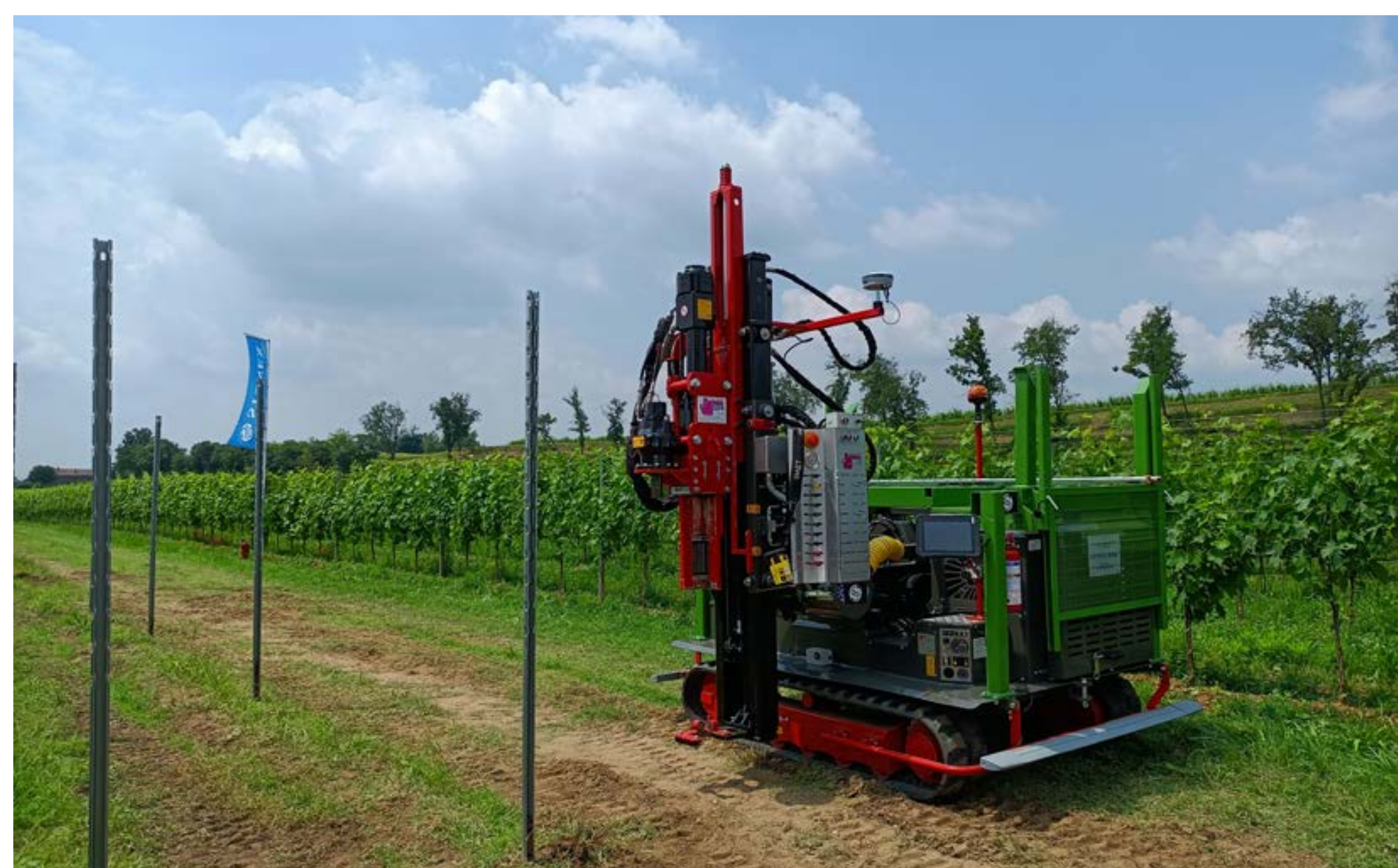
Macchina battipalo Pauselli equipaggiata con il sistema STX-SUITE di Stonex
