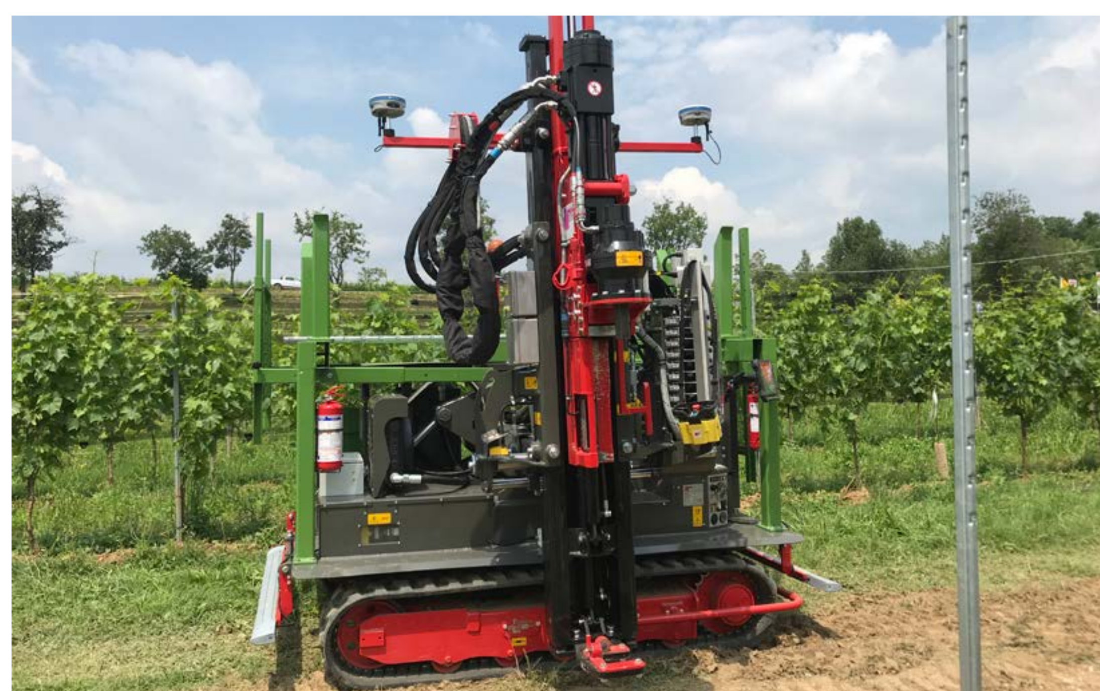
Macchina battipalo Pauselli dotata della soluzione Stonex dotata di 2 GPS.
